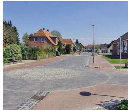
Verkehrsberuhigung: Verschwenkungen (oben) und Aufpflasterungen in den Kreuzungsbereichen (Bild rechts) sollen dazu führen, dass Verkehrsteilnehmer dort demnächst Tempo 30 einhalten.
